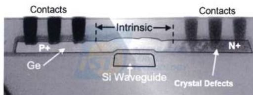
圖4 TEM觀察Ge-PIN的斷面結構影像 [4]
